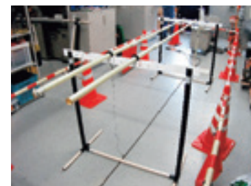
写真2：絶縁棒耐電圧検査のようす
