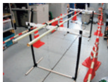
写真2：絶縁棒耐電圧検査のようす
