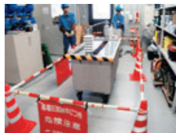
写真1：絶縁ゴム手袋耐電圧検査のようす
